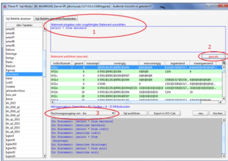
Im oberen Fenster (1) können SQL-Abfragen zusammengestellt werden, die dann mit **Execute** (2) ausgeführt werden. Das Ergebnis wird dann im mittleren Fenster angezeigt.
